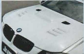
SEIBONのカーボンボンネットに、アウトレットダクトを2つ追加してよりスポーティなイメージをプラスしている。
