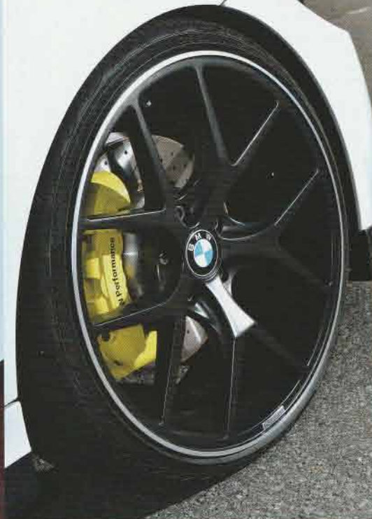
20"ジオパナPORTOFINOをセット。センターのBMWマークはオーナーが持ってきたとか。ブレーキはBMWパフォーマンスのキットに交換し、ボルシェと同じレモンイエローでペイント。サスは3Dデザイン車高調だ。
