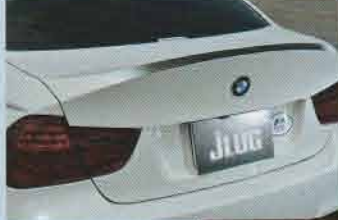
DUKEダイナミクスのダックテールタイプカーボントランク。ダックテールトップ部に、あえてグラデでカーボンパターンを残す。
