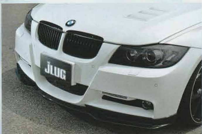
フロントバンパーにはend.c.cのカーボンリップをマウント。両サイドダクトにはアダプターから作ったというオリジナルのデイトライトがセットされ、よりシャープなマスクに。
