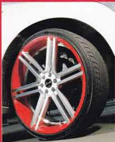
採用されたホイールは24インチの「Gianelli BOLOGNA」。ちなみにSRXのP.C.D.は特殊で、6/120というサイズ設定。よってこのホイールは本誌でのワンオフ製作となっている。タイヤは275/30ZR22 (FALKEN)。
